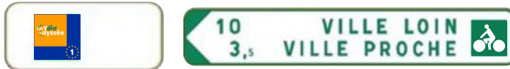
Panneau de signalisation « Directionnelle vélo » avec identifiant de l'itinéraire avec logo indépendant
